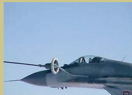
Дозаправка в воздухе самолета МиГ-29БМ. На испытаниях в качестве танкера использовался фронтовой бомбардировщик Су-24М, оснащенный унифицированным подвесным агрегатом заправки УПАЗ
