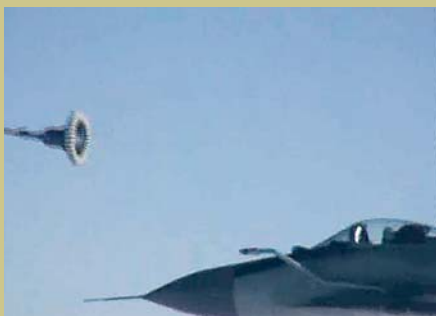
Дозаправка в воздухе самолета МиГ-29БМ. На испытаниях в качестве танкера использовался фронтовой бомбардировщик Су-24М, оснащенный унифицированным подвесным агрегатом заправки УПАЗ
