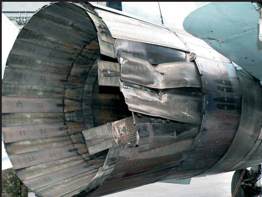
Вверху и справа: повреждения конструкции Су-33 №88, которые он получил в результате обрыва троса аэрофинишера во время посадки 5 сентября 2005 г.: пробитая обшивка стабилизатора и деформированные створки сопла левого двигателя. Отремонтировать самолет удалось прямо в условиях корабля
