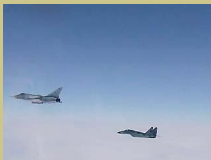
Дозаправка в воздухе самолета МиГ-29БМ. На испытаниях в качестве танкера использовался фронтовой бомбардировщик Су-24М, оснащенный унифицированным подвесным агрегатом заправки УПАЗ
